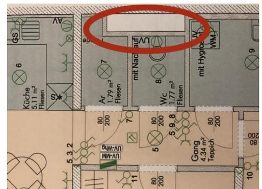
Ebenso gilt auch für einen Bereich von 50cm rund um die Loggiatüren ein absolutes Bohrverbot, da sonst die Gefahr einer Beschädigung der Loggia-Verankerung bestehen könnte. Hier sind auch selbstverständlich jegliche Stemmarbeiten, wie generell in der gesamten Wohnung, absolut verboten.
